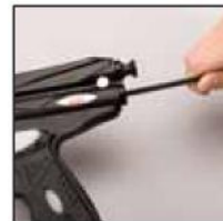
FIGURA 6. LA LLAVE DE 1/8" ALLEN USADA PARA AJUSTAR LA VELOCIDAD
