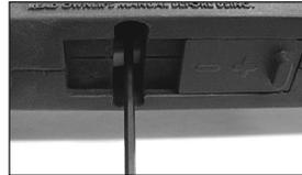
**Para aumentar a velocidade** - Desparafuse ou relaxe o parafuso de ajuste da velocidade girando-o para o lado esquerdo do marcador (ao contrário da direção dos ponteiros do relógio). Gire o parafuso de ajuste da velocidade ao contrário da direção dos ponteiros do relógio em pequenos movimentos, paran-
